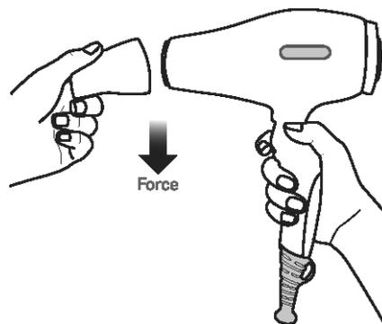
Um die Düse vom Trockner zu entfernen, biegen Sie bitte die Düse gerade nach unten, wie oben gezeigt, versuchen Sie nicht, die Düse gerade heraus zu ziehen
